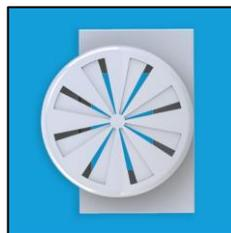
Les bouches d'extraction d'air hygroréglables possèdent une section de passage qui varie pour faire varier le débit en fonction de l'humidité de l'air qui la traverse. La section de la bouche d'extraction augmentant proportionnellement au taux d'humidité de la pièce, elle s'adapte « automatiquement » à l'occupation et aux usages des habitants.
